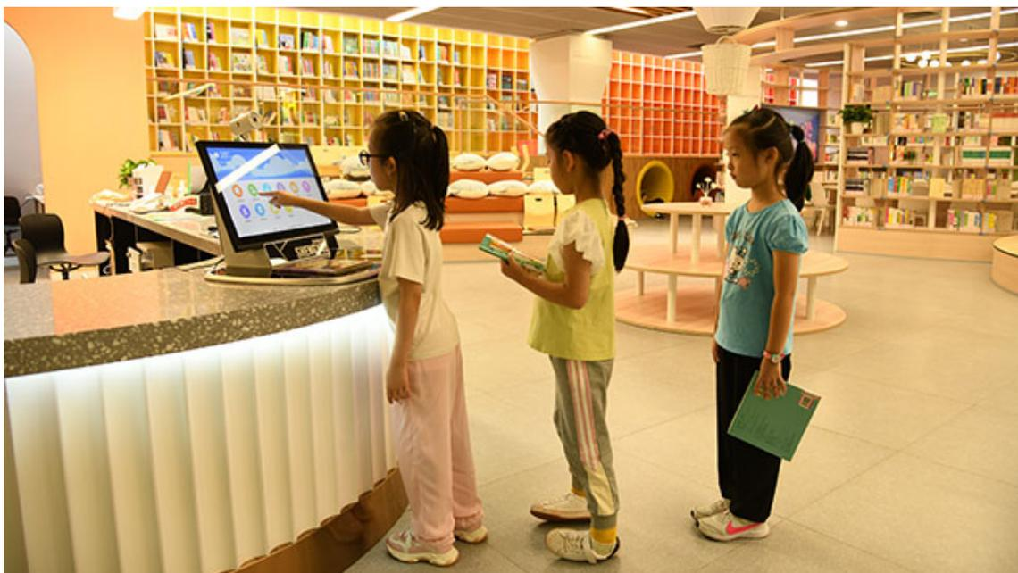
声阅自助借还功能特点包括：自动借还书机具备自助借书、还书、续借和超期查询等功能；操作界面伴有语音和文字提示，简洁直观明了、操作方便快捷；还书机内置还书箱，方便用户放置图书；系统采用视频多书侦测技术，不受磁条和书籍摆放位置的影响，防止一码多借的错误；具有两个以上的红外感应器，防止借阅时书籍被抽换；具有视频管理功能，系统能够抓拍读者借还书过程，将证件号码、时间等信息叠加到图像上；采用标准数据接口，能够对接主流图书馆管理系统；系统支持条形码、一卡通等多种借阅方式；系统提供远程异常报警功能，以短信等方式将异常情况通知管理员；支持远程查看、控制和管理设备运行；支持WEB查询统计，可以生成报表或者图表；实时打印借还书凭证。自助借还是图书发展到一定程度演变出来的自主协助借还。
